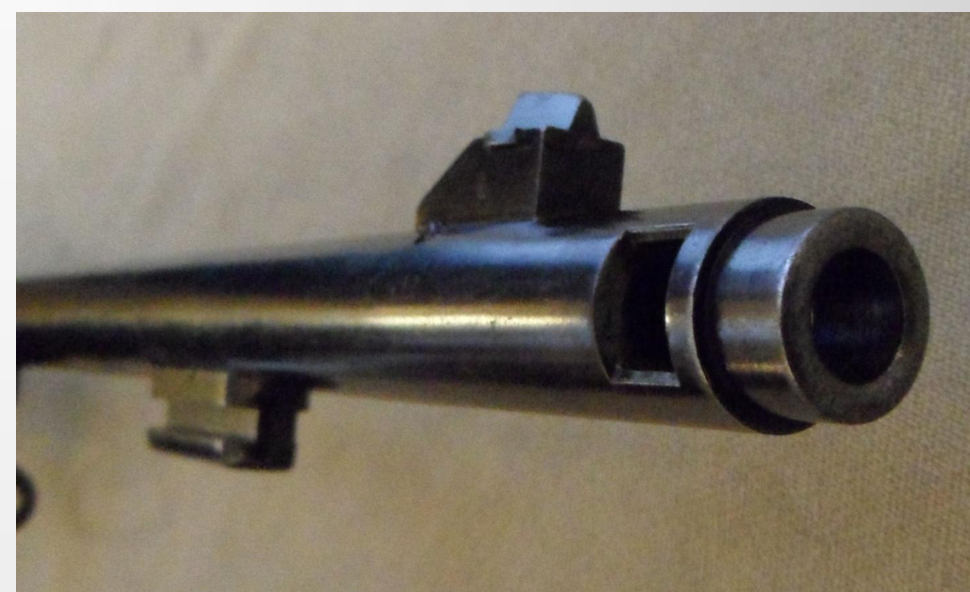
Muszkla, obsada bagnetu i hamulec wylotowy.
